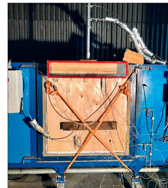
Versuchsaufbau zur Bestimmung der Rauchdichtheit, links als Schemazeichnung, rechts als realisierte Testanlage
