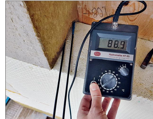
Bestimmung der Holzfeuchte an einem Massivholzbauteil hinter nasser Wärmedämmung
