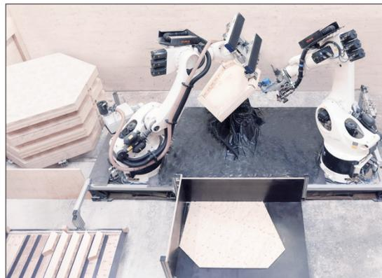
Robotische Fertigung der Kassetten für den Buga-Pavillon im Werk von Müllerblaustein
